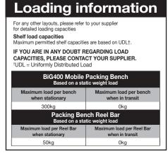
MOBILE WORKBENCHES ARE INTENDED FOR RELOCATION ONLY. REMOVE LOAD BEFORE RELOCATION.
