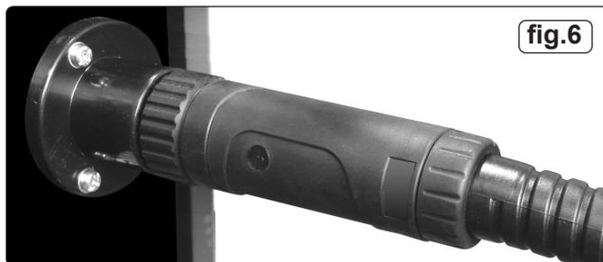
4.6. **CONNECT THE TORCH CABLE TO THE WELDER.**
